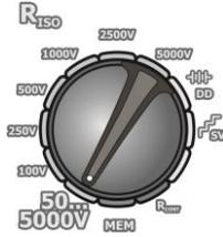
Der Drehschalter zur Funktionsauswahl sollte auf einer der Positionen eingestellt werden **R<sub>ISO</sub>**, mit gleichzeitiger Auswahl der Messspannung (Position **50...5000V** alle 10V in dem Bereich gewählt 50 V...1 kV je 10 V, 1 kV...5 kV je 25 V). Das Messgerät befindet sich im Modus zur Spannungsmessung.
